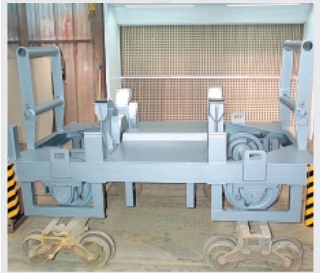
Chariot automoteur pour conteneurs secteur nucléaire, charge 6 t Automotor truck for container for nuclear power, load 6 t
