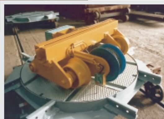
Chariots spéciaux pour charge de 300 t avec plateforme pivotante pour inscription en courbe - poids d'un bogie : 11 t Special carriages for 300 t load, with pivoting platform for entry into curve - load of 1 bogie: 11 t
