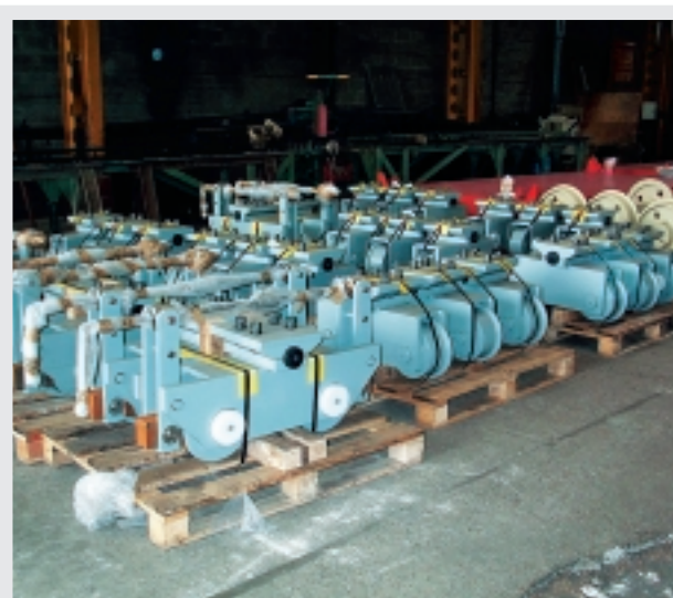
Bogies freinés de capacité 20 T Brake bogie load 20 T
