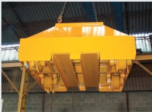
Chariot manuel de montage rotors, charge 40 t, hauteur 0,9 m Manual truck for rotors, load 40 t, high 0,9 m
