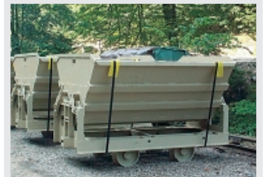
Wagon voie de 800 - 2100 litres - wagon gauge 800 - 2100 litres
