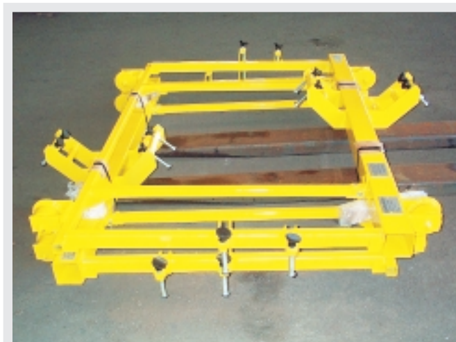
Chariot manuel pour manutention de moteur Manual truck for motors handling
