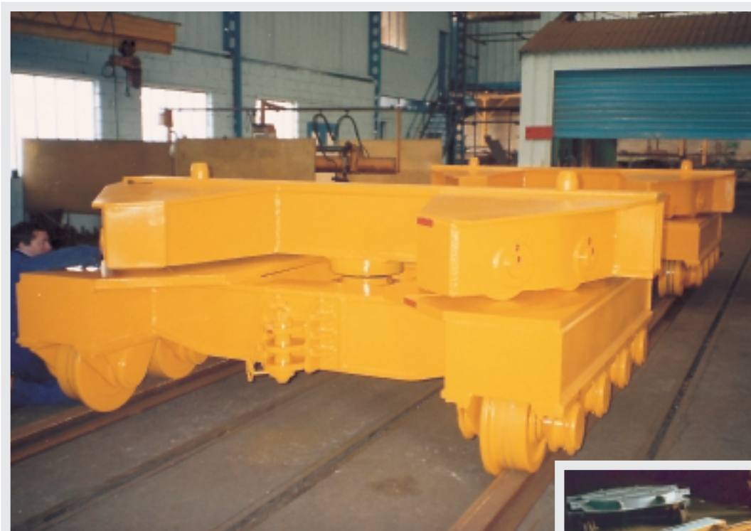
Chariots spéciaux pour charge de 300 t avec plateforme pivotante pour inscription en courbe - poids d'un bogie : 11 t Special carriages for 300 t load, with pivoting platform for entry into curve - load of 1 bogie: 11 t
