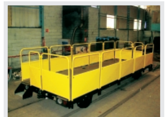
Plateformes ferroviaire 6 m x 6.370 m, 5 t voie 1440 mm Rail platform 6 m x 6.370 m, 5 t gauge 1440 mm
