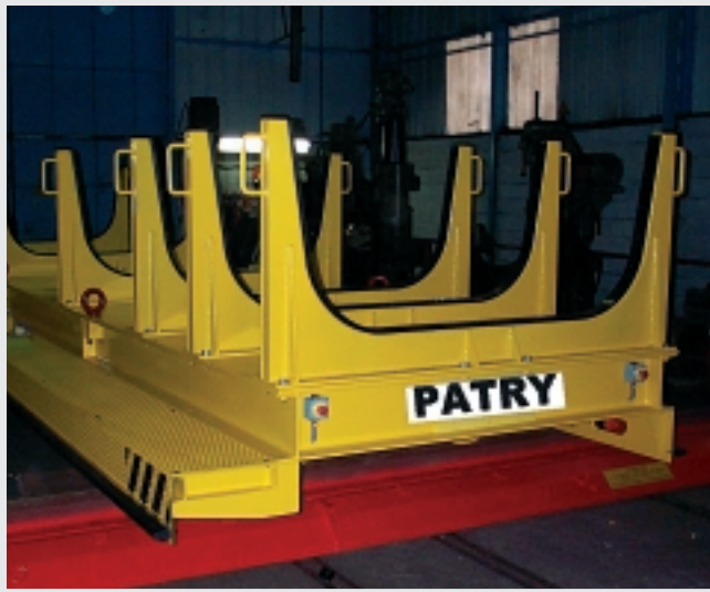
Transbordeur 8 m x 2 m, automoteur, conducteur embarqué, charge 6 t Track transfer, auto motor, driver on board, load 6 t
