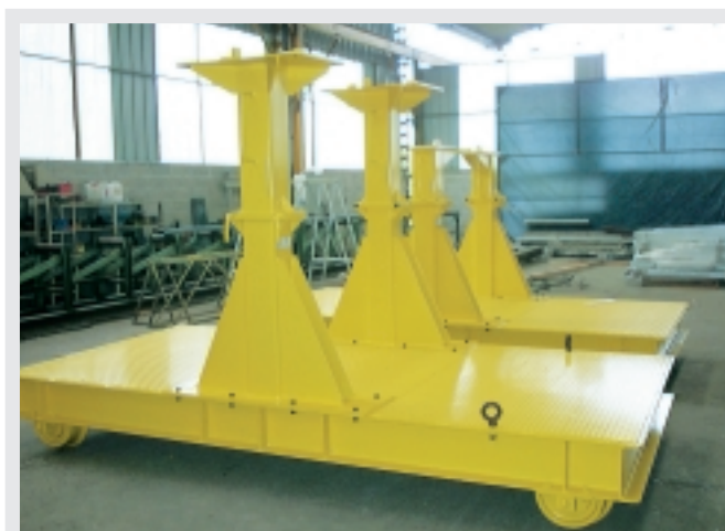
Chariot avec chandelle basculante , 10 t par chandelle, voie 1440 mm, charge 20 t Truck with vertical support, 10 t per support, gauge 1440 mm, load 20 t
