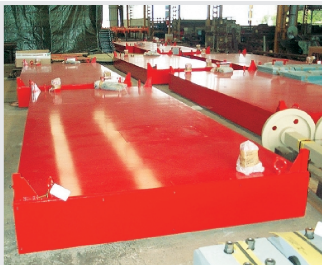
Chariot motorisé 4,820 m x 2,198 m pour industrie automobile, charge 10 t
