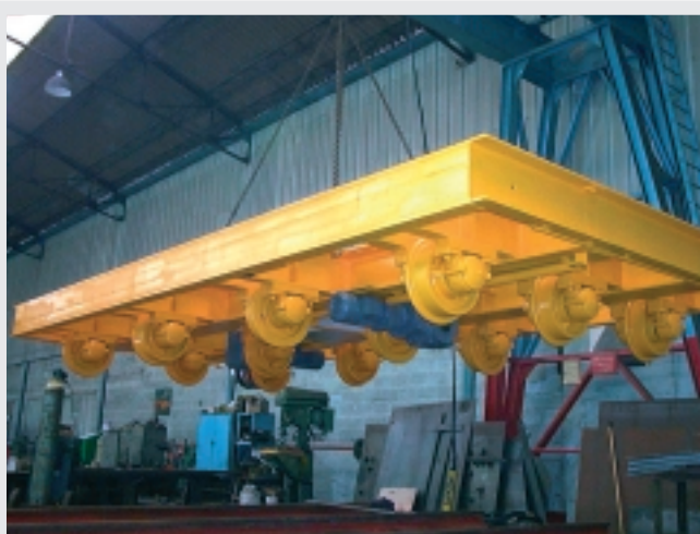
Chariot charge 90 t pour transport moteurs marins Truck load 90 t for marine motors transport
