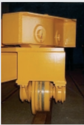
Roue pour forte charge, montage sur roulements coniques. Wheel for heavy load, fitting on taper-bearings
