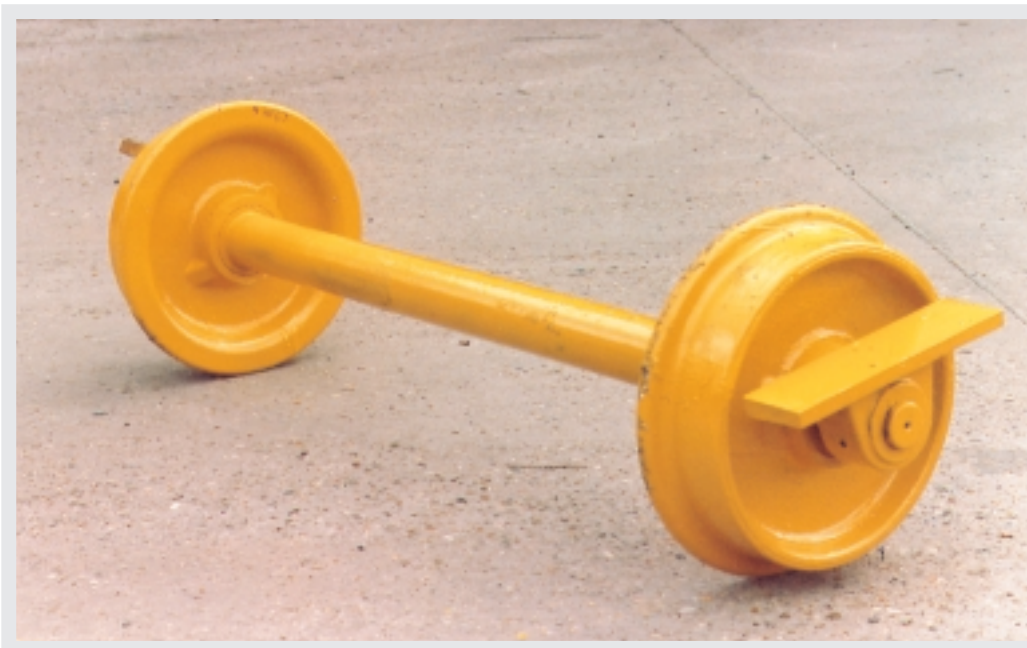
Essieu roue 300 M Voie 1440 charge : 5 t
