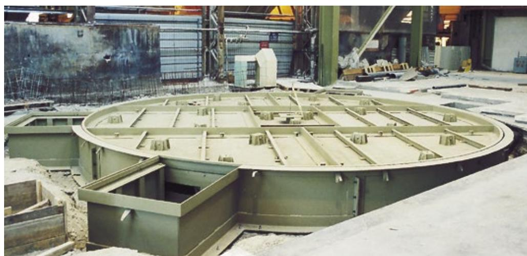
Plaque tournante diamètre : 7,5 m - charge 16 T en tous points - motorisation électrique rotation 360°
