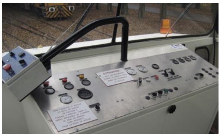
Pupitre de contrôle avec boîtier de commande rotatif
