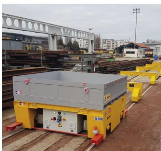
Chariot motorisé sur batteries 10 T avec bac
