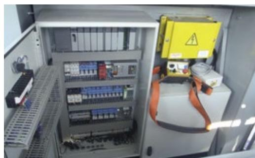
Kit radiocommande complet sur Moyse BN40
