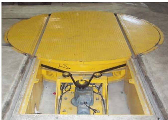
Plaque tournante motorisée charge 10 t, diamètre 2,6 mètres
