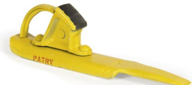
Si mouvement de wagon, ces sabots permettent d'arrêter progressivement et sans secousse un wagon ou une rame de plusieurs wagons sur une longueur de quelques mètres. Pour obtenir l'arrêt, il suffit d'employer un seul sabot placé à volonté sur l'un ou l'autre des rails, sauf dans le cas d'une courbe où il doit être placé sur le rail intérieur.
