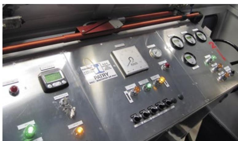
Pupitre de contrôle de locotracteur MTE T1951 rénové avec mise en place des agrès de sécurité
