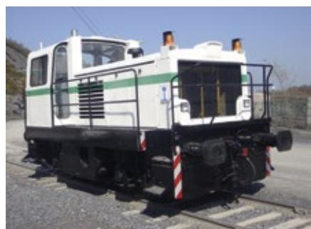
Locotracteur Moyse BN44 EE radiocommandé
