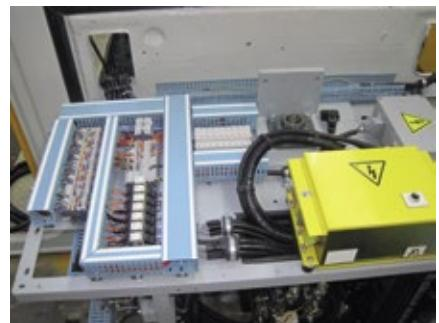
Pupitre électrique avec récepteur de radio sur BB Fauvet Girel
