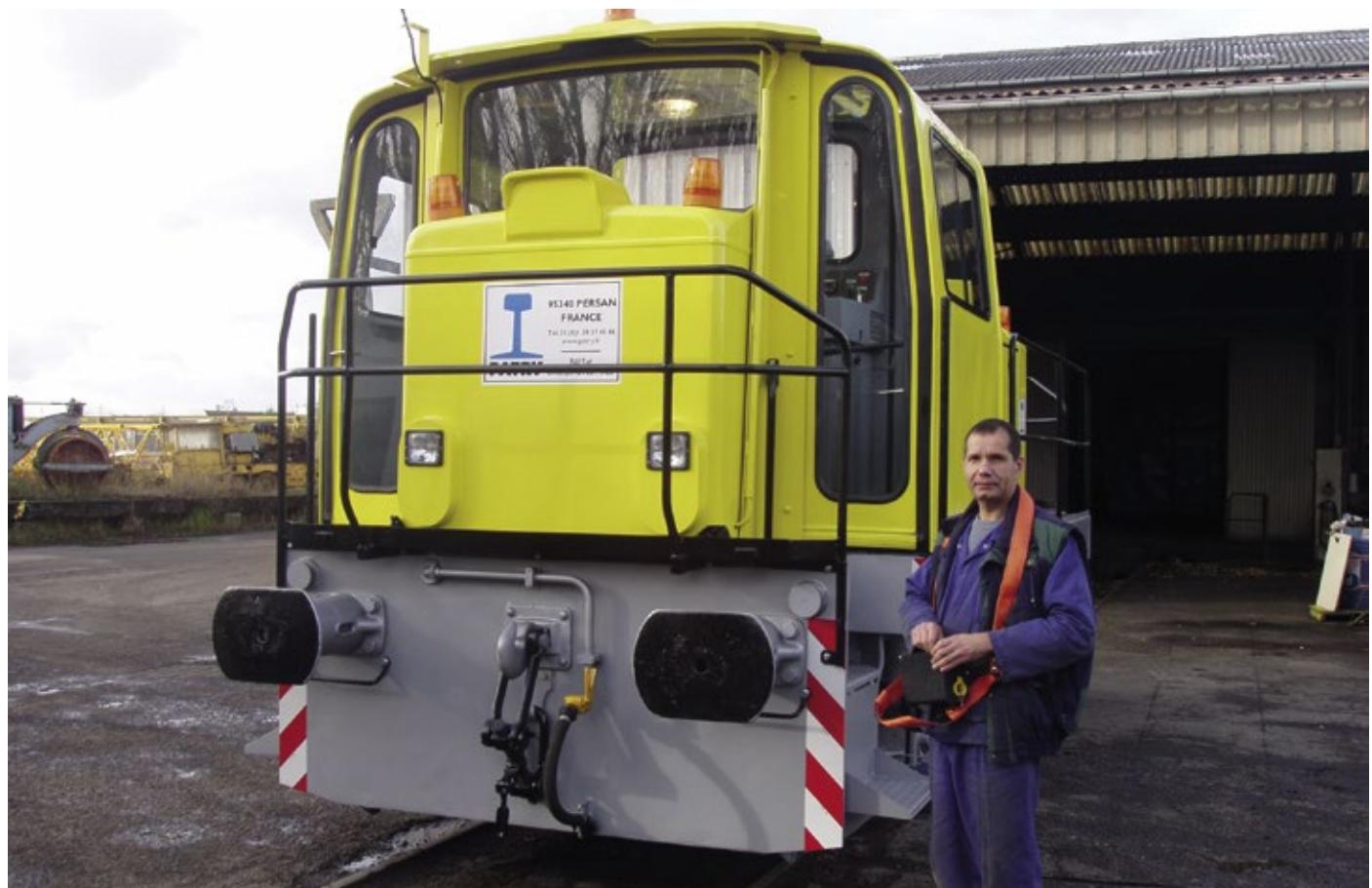
Locotracteur Moyse BN44 EE radiocommandé
