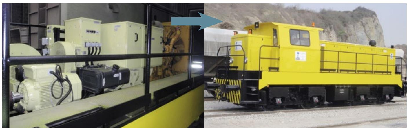
Compartment moteur diesel avec alternateur de locotracteur BB Fauvet Girel 72 t
