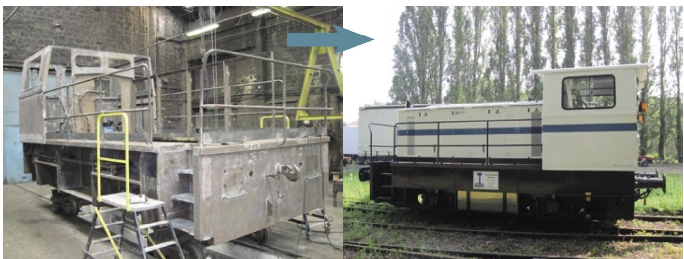
Chassis en cours de rénovation de locotracteur Fauvet Girel 300 CV
