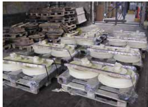
Roues 600 avec arbres frettés Wheels 600 machined
