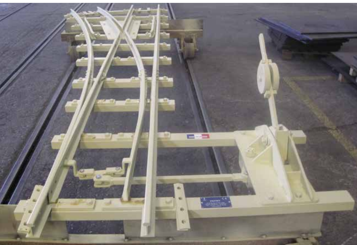
Aiguillage voie de 400 Switch with gauge 400
