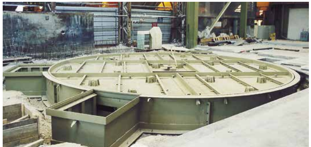
Plaque tournante diamètre : 7,5 m - charge 16 T en tous points - motorisation électrique rotation 360° Turntable Diameter 7,5 m - 16 T load at all points - electric motor driven revolution 360°
