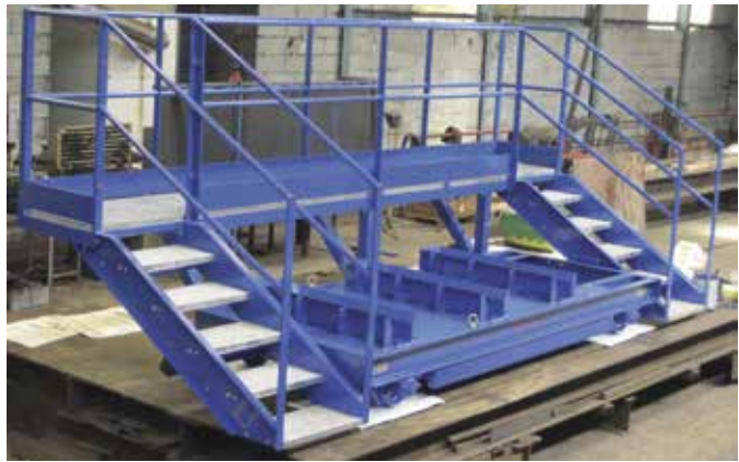
Chariot électrique 6 T Electric powered trolley, load 6 T
