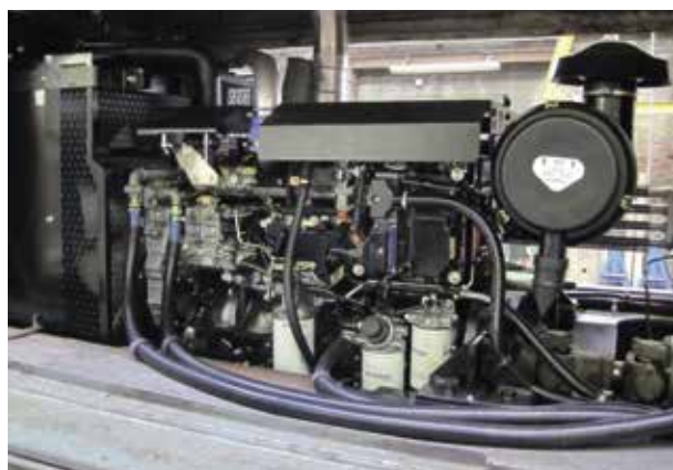
Remotorisation sur locotracteur Y5000 Remotorization of a locomotive Y5000
