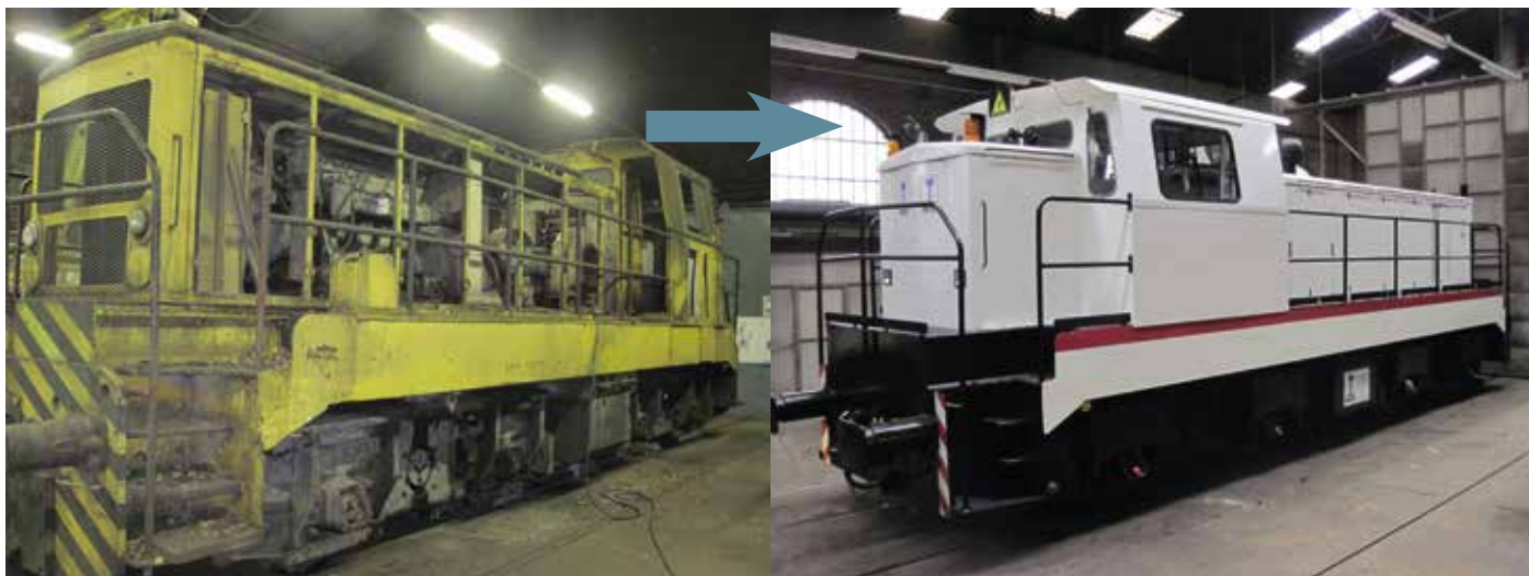
Locotracteur BB Favet Girel 72 t avant rénovation Locomotive BB Favet Girel 72 tons before refurbishment
