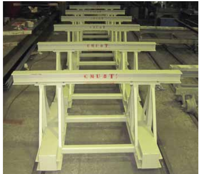
Chariot manuel 8 T, pour cabine de peinture Manual trolley load 8 T, for painting booth
