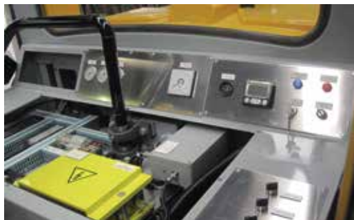
Pupitre avec récepteur de radiocommande Drive control desk with remote control receiver
