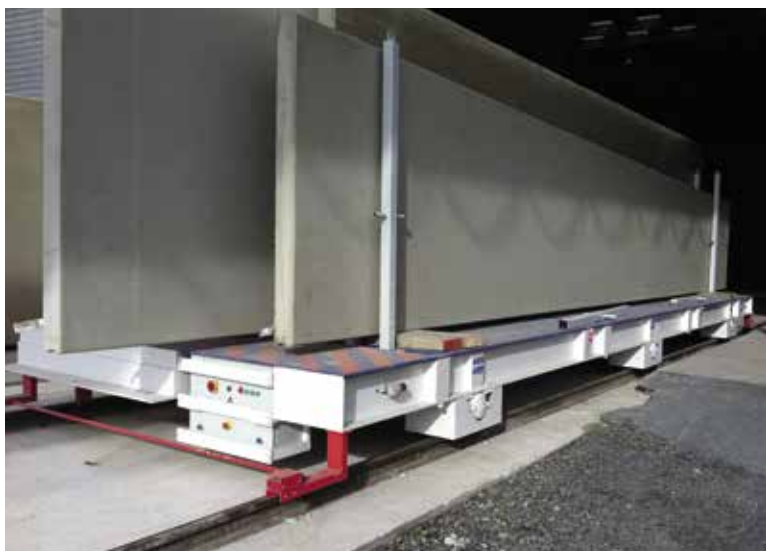
Chariot électrique 100 T Electric trolley, load 100 T
