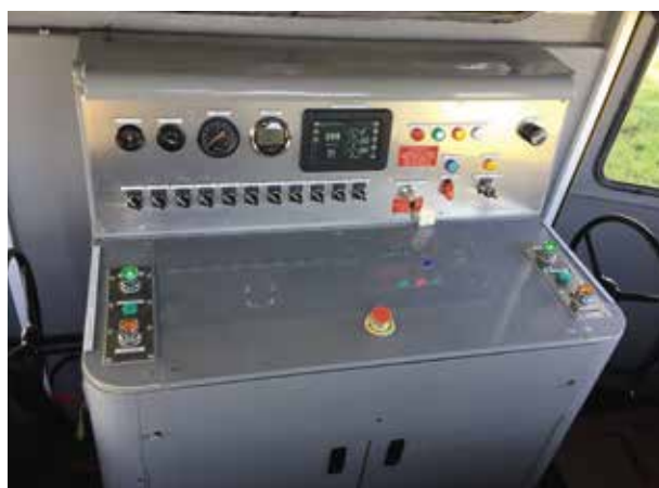
Pupitre rénové sur locotracteur Renault 020 DH Refurbished Drive control desk of a locomotive Renault 020 DH
