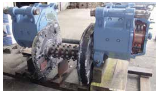
Dépose moteur de traction Pulling engine removal
