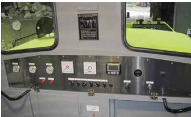
Pupitre de contrôle de locotracteur Moyse BNC (2009) Driven control desk of a locomotive Moyse BNC (2009)
