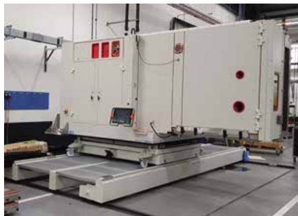
Transbordeur motorisé 7 T Powered traverser, load 7 T
