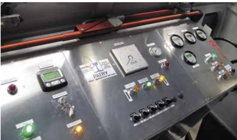
Pupitre de contrôle de locotracteur MTE T1951 rénové avec mise en place des agrès de sécurité Reconditioned driven control desk of a locomotive MTE T1951 with safety apparatuses installed
