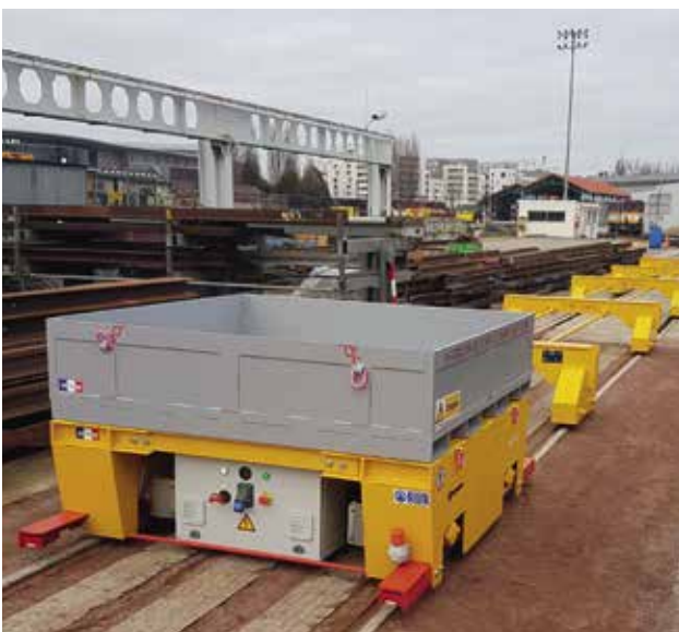
Chariot motorisé sur batteries 10 T avec bac Electrical powered trolley on batteries, load 10 T, with metal casing
