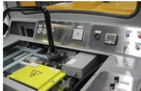
Pupitre avec récepteur de radiocommande
