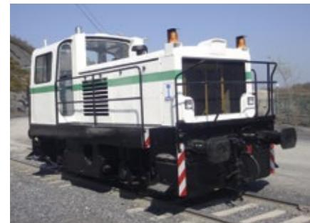
Locotracteur Moyse BN44 EE radiocommandé
