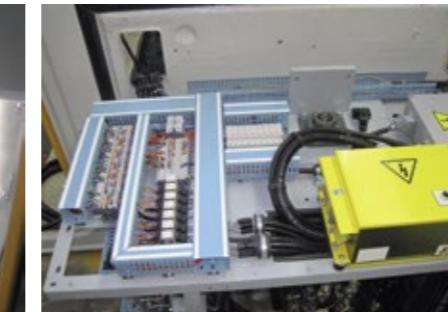
Pupitre électrique avec récepteur de radio sur BB Fauvet Girel
