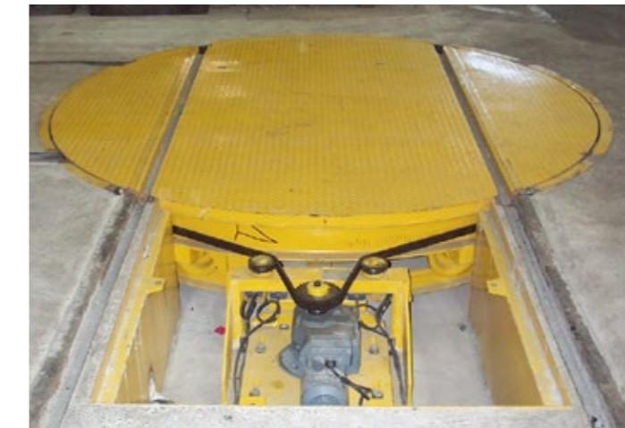
Plaque tournante motorisée charge 10 t, diamètre 2,6 mètres
