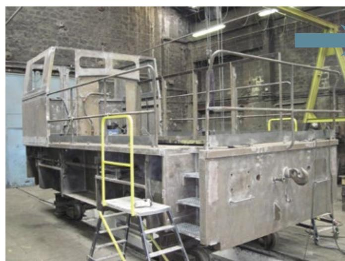
Chassis en cours de rénovation de locotracteur Fauvet Girel 300 CV
