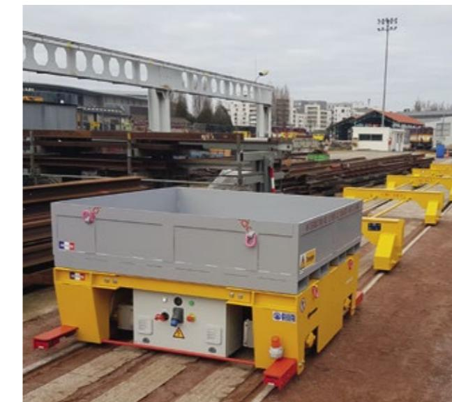
Chariot motorisé sur batteries 10 T avec bac
