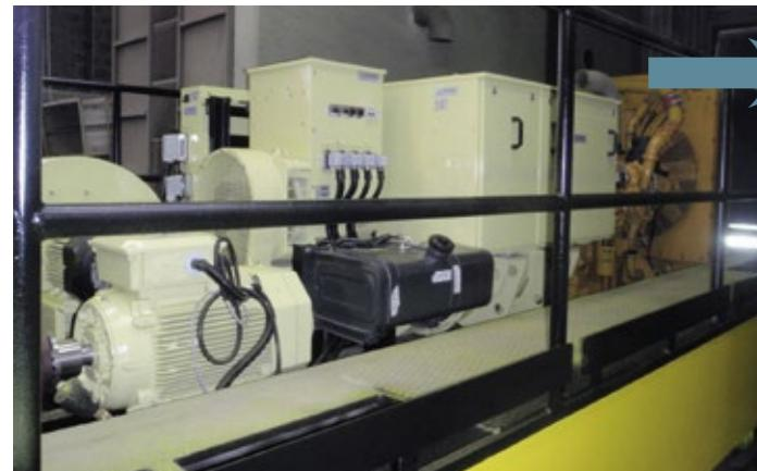
Compartiment moteur diesel avec alternateur de locotracteur BB Fauvet Girel 72 t
