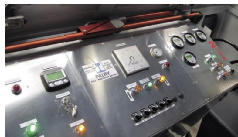
Pupitre de contrôle de locotracteur MTE T1951 rénové avec mise en place des agrés de sécurité
