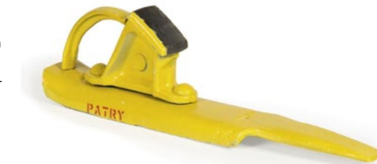
Si mouvement de wagon, ces sabots permettent d'arrêter progressivement et sans secousse un wagon ou une rame de plusieurs wagons sur une longueur de quelques mètres. Pour obtenir l'arrêt, il suffit d'employer un seul sabot placé à volonté sur l'un ou l'autre des rails, sauf dans le cas d'une courbe où il doit être placé sur le rail intérieur.
