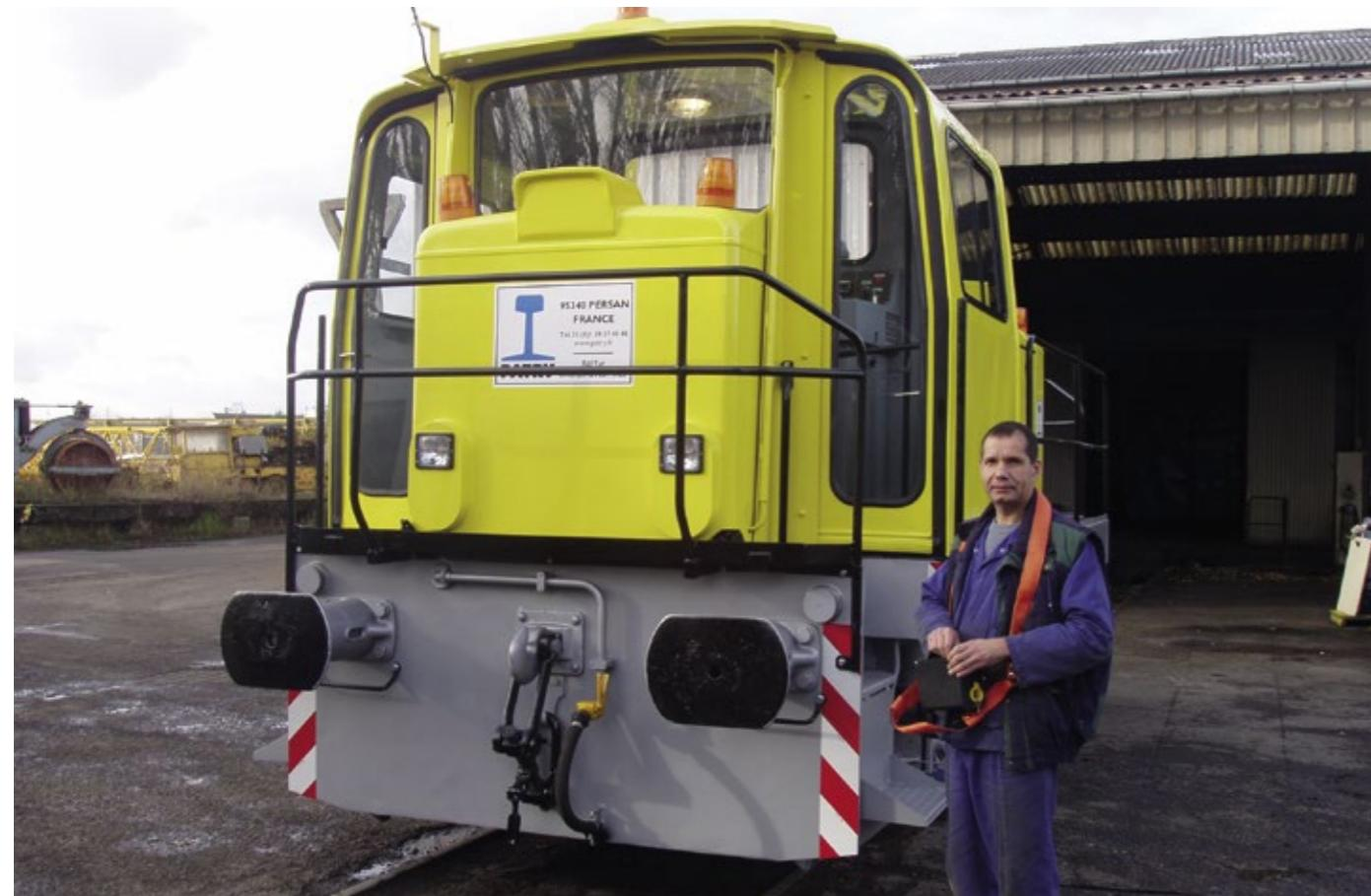
Locotracteur Moyse BN44 EE radiocommandé
