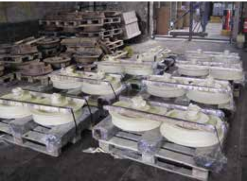
Roues 600 avec arbres frettés Wheels 600 machined
