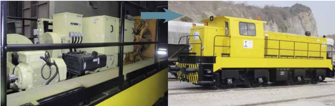
Compartiment moteur diesel avec alternateur de locotracteur BB Favuet Girel 72 t Diesel engine with alternator of a locomotive BB Favuet Girel 72 tons
