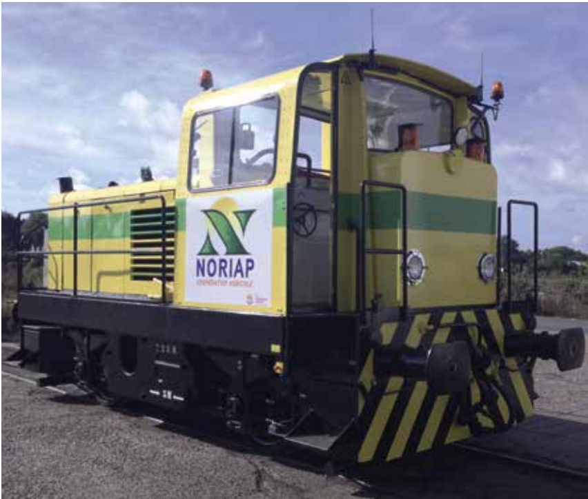
Locotracteur MOYSE BN40 rénové (2009) Refurbished locomotive MOYSE BN40 (2009)
