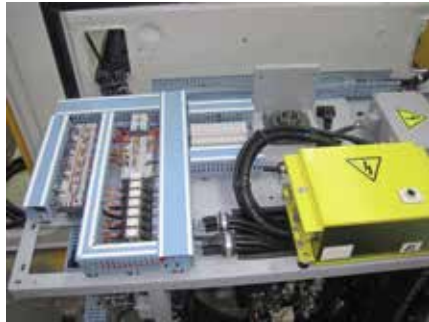
Pupitre électrique avec récepteur de radio sur BB Fauvet Girel Electrical control desk with remote control receiver of BB Fauvet Girel
