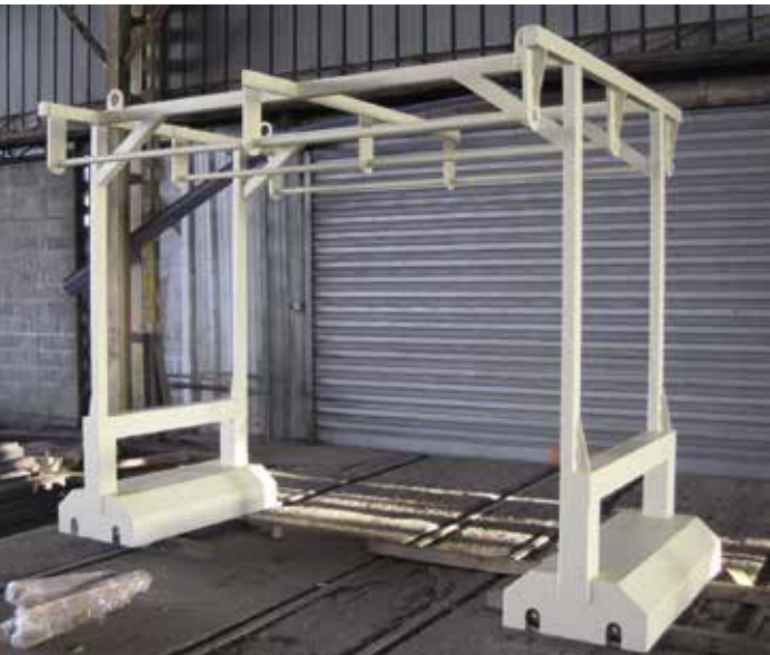
Lorry suspente 1 T, pour cabine de peinture Specific lorry 1 T, for painting booth
