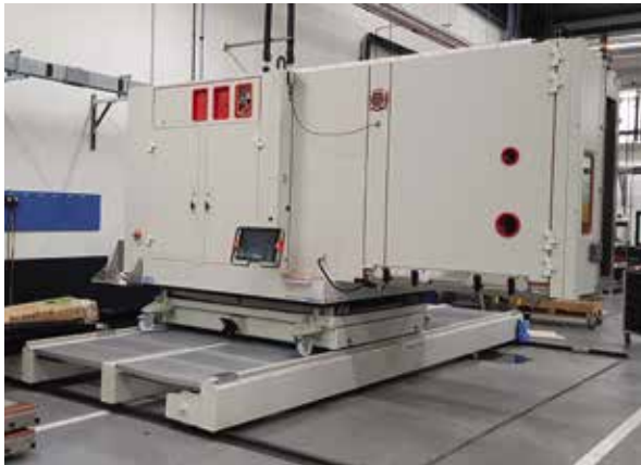
Transbordeur motorisé 7 T Powered traverser, load 7 T
