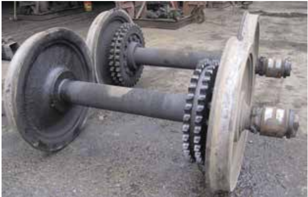
Essieux reprofilés avec fiches suiveuses Turned axles
