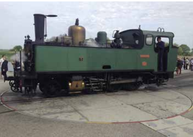
Plaque tournante motorisée, 60 t, diam. 8,5 m, plateau lisse, rotation 360° Motor driven turntable, 60 t, diam. 8,5 m, smooth table, 360° rotation
