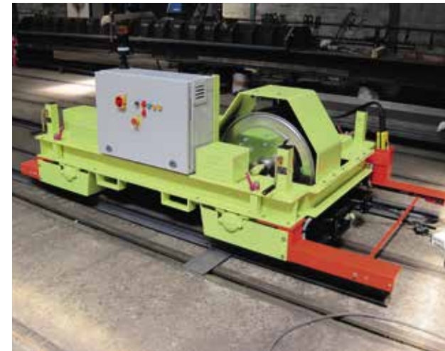
Chariot motorisé pour bras manipulateur Electric powered trolley for manipulating arm
