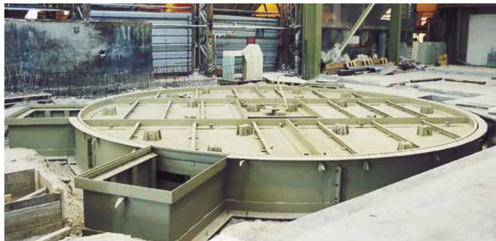
Plaque tournante diamètre : 7,5 m - charge 16 T en tous points - motorisation électrique rotation 360° Turntable Diameter 7,5 m - 16 T load at all points - electric motor driven revolution 360°
