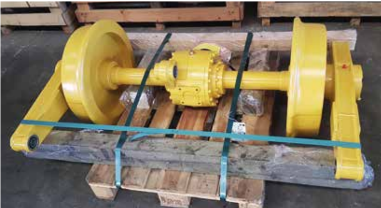
Essieu avec pont et bras articulés en voie Axle with driving axle and arm
