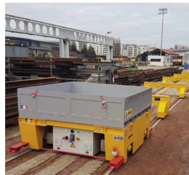
Chariot motorisé sur batteries 10 T avec bac Electric powered trolley on batteries, load 10 T, with metal casing
