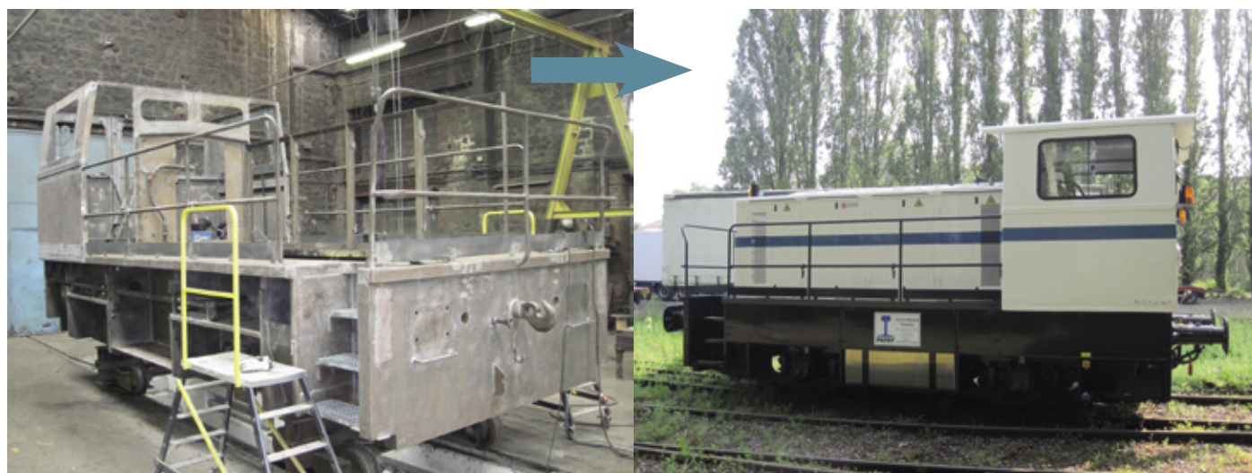
Chassis en cours de rénovation de locotracteur Fauvet Girel 300 CV Chassis of a locomotive Fauvet Girel 300 HP during renovation
