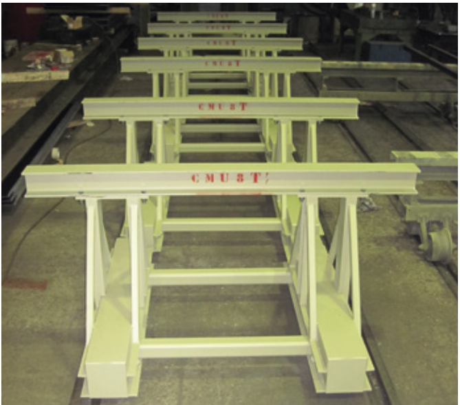
Chariot manuel 8 T, pour cabine de peinture Manuel trolley load 8 T, for painting booth
