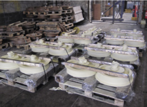
Roues 600 avec arbres frettés Wheels 600 machined
