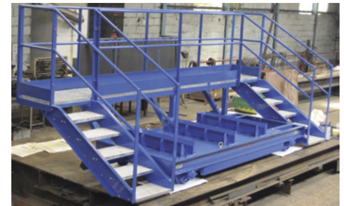
Chariot électrique 6 T Electric powered trolley, load 6 T
