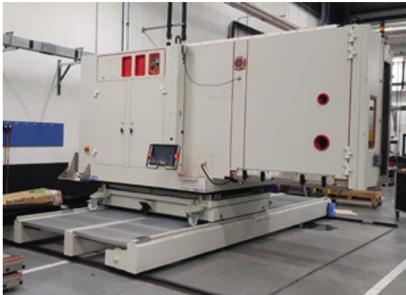
Transbordeur motorisé 7 T Powered traverser, load 7 T
