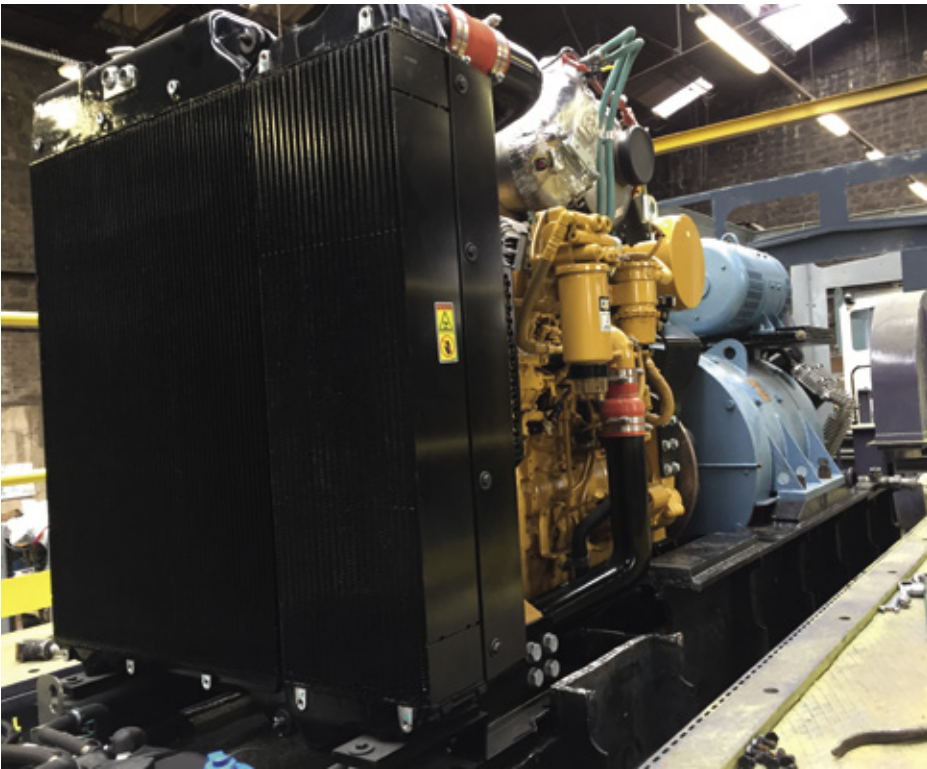
Remotorisation en CATERPILAR C9.3B étape V Remotorization with a CATERPILAR C9.3B
