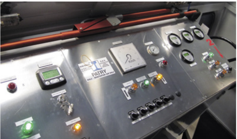
Pupitre de contrôle de locotracteur MTE T1951 rénové avec mise en place des agrès de sécurité Reconditioned driven control desk of a locomotive MTE T1951 with safety apparatuses installed
