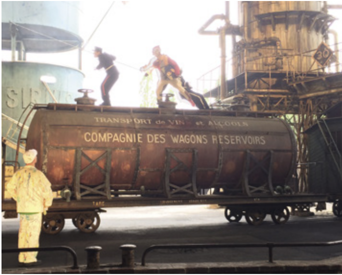
Parc Astérix : Wagons automoteurs sur batterie (3 chariots, charge 2t) Asterix amusement park : Self-propelled battery wagons (3 trolleys, load 2t)
