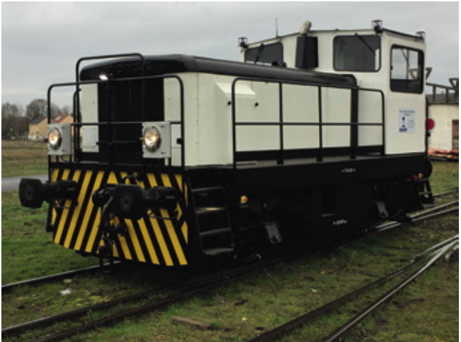
Locotracteur MOYSE BN44EE rénové avec agréments et radiocommande (2018) Remote control with full accreditation (2018)
