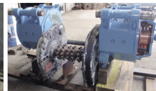
Dépose moteur de traction Pulling engine removal
