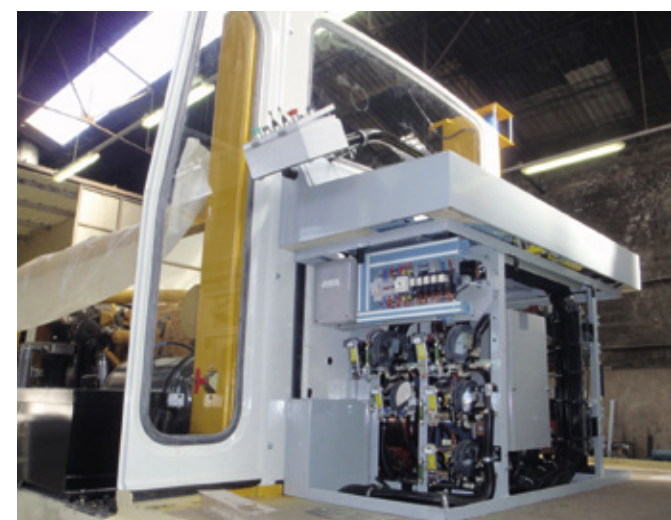
Pupitre rénové d'un locotracteur Moyse CN 60 Drive control desk of locomotive Moyse CN 60 reconditioned as new
