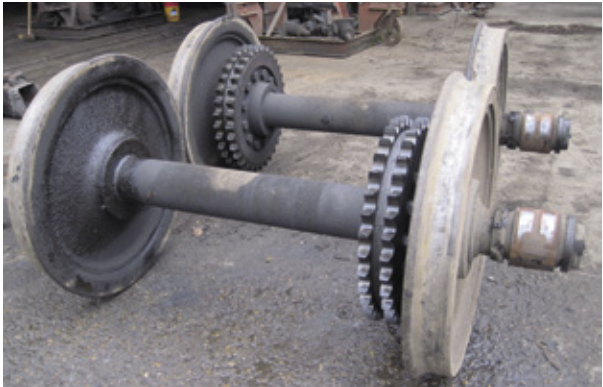
Essieux reprofilés avec fiches suiveuses Turned axles
