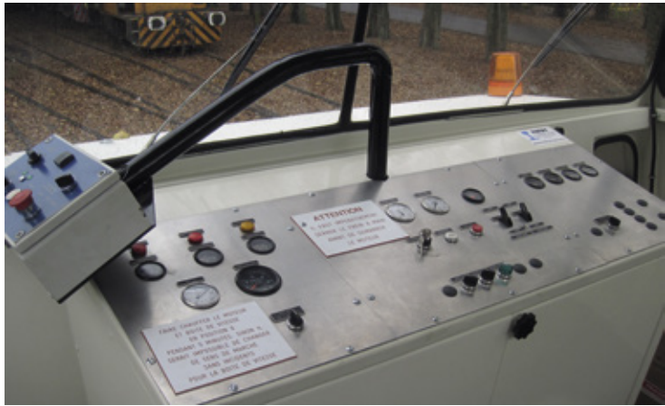
Pupitre de contrôle avec boîtier de commande rotatif Drive control desk with rotative remote control
