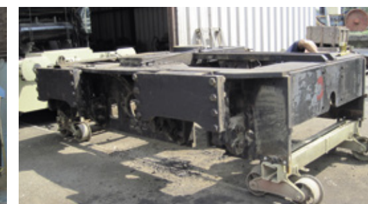
Remise en état de bogies Bogies restoring
