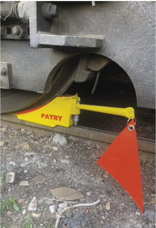
Cale antidérive avec drapeau rouge Wedge for wagon immobilization with red flag
